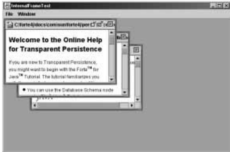
Rysunek 6.45. Rozmieszczenie kaskadowe ramek wewnętrznych
